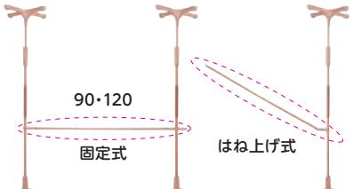
部屋から廊下への動線上に手すりを設置したい場合や複数連結・斜め取り付けが可能です。
