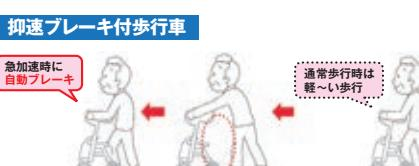
急加速時ののみ自動的にブレーキが作動して「転倒防止!」
